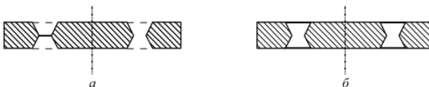
Рис.1.3. Виды симметричного подвеса инерционной массы относительно ее центра масс
