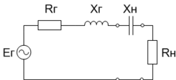
Рисунок 5.3 – Пример простейшей согласующей цепи.
