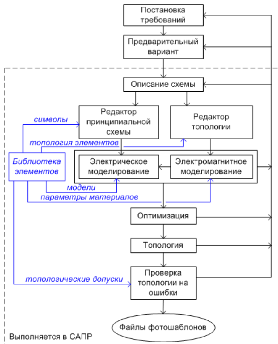
Рисунок 1.5 – Блок-схема автоматизированного проектирования
