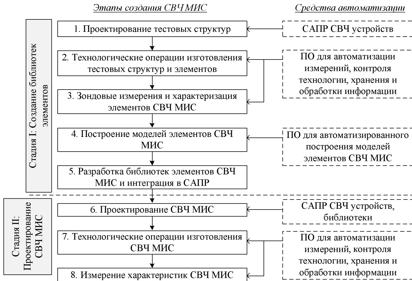
Рисунок 1.1 – Схема процесса проектирования и изготовления МИС на отечественной технологии и средства его автоматизации
